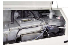
チタン製はんだ槽および冷却ユニット Titanium solder bath and cooling unit
